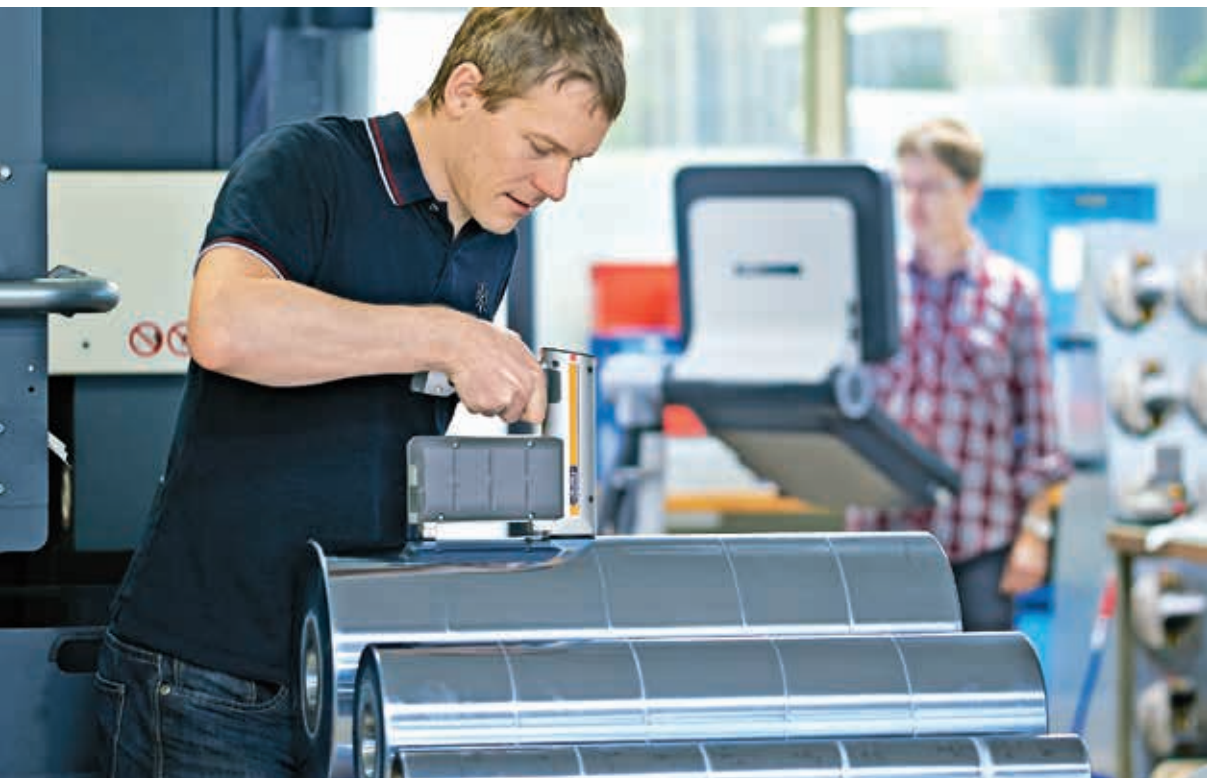
Hightech für die Qualitätskontrolle: Messgeräte auf Röntgenfluoreszenzbasis
